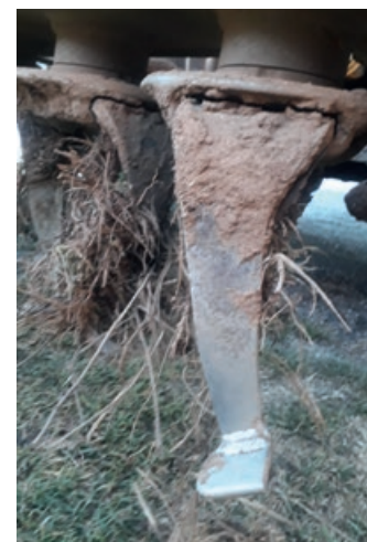
Herse rotative modifiée, partie horizontale soudée (mise de socle) à un angle de 30° et à 3 cm au-dessus du bout de la dent.
