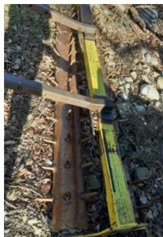
Double rouleau à dents de marque Altos ajouté derrière un Terrano. Le deuxième rouleau est inversé et de plus faible diamètre, ce qui facilite la projection des racines en surface.
