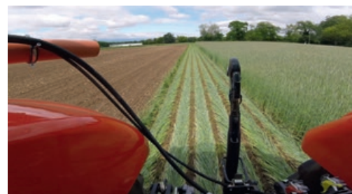
Diviseur frontal (écartement de 60 cm) fixé à l'avant du rouleau faca, photo de gauche et, photo de droite, résultat du diviseur dans un seigle semé à 330 kg et roulé à épiaison.
