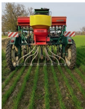
Semoir de relay-cropping, enjambeur de maraîcher et éléments semeurs d'Amazon Condor, écartement de 30 cm.
